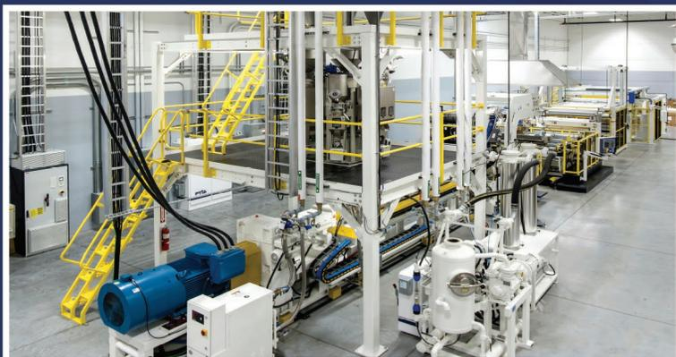
TDC LINEA 1: MODELO HVTSE@ 85mm-52D DryerLESS™ EXTRUSIÓN DE HOJA MULTIRESINA A TRAVÉS DEL ENROLLADOR PARA TASAS DE HASTA 2.200 PPH
