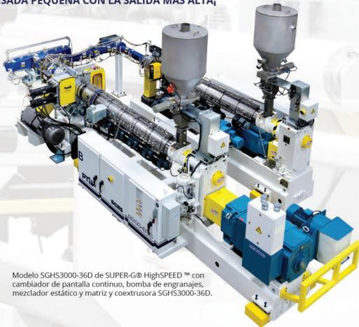
Modelo 5GH53000-36D de SUPER-G® HighSPEED™ con cambiador de pantalla continuo, bomba de engranajes, mezclador estático y matriz y coextrusora 5GH53000-36D.
